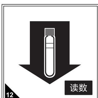
再放入待测样，按读数直接读取COD浓度(mg/L)，期间无需拧开瓶盖，必须保证液面中间为澄清状态，如有絮状沉淀应待沉淀完全沉下或采用离心操作，否则读数偏差较大。
