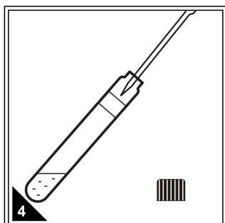
使用移液管或移液枪准确移取5.00mL的无氨水加到预制试剂内制成空白样。
