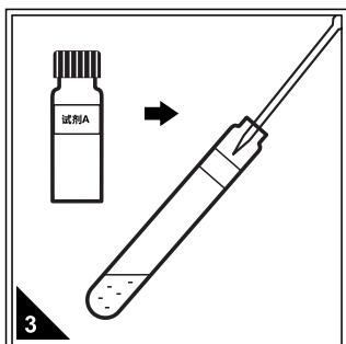
准确移取1.00mL试剂A于每支试剂管中。
