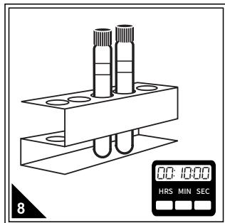
将试管样放在试管架内，使其反应并准确计时10分钟。
