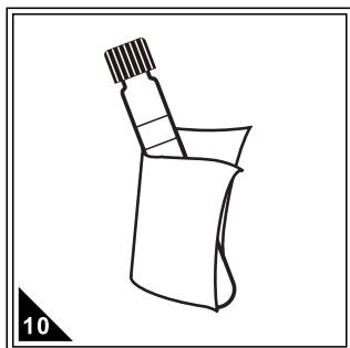
取出反应好的试管样，用擦镜布或无毛屑的软纸擦干净试管外壁。（读数请在10分钟内完成操作）
