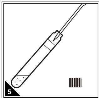
按步骤4的方法移取同体积的待测水样加入到其他预制试剂的试管内，每支预制试剂对应一个待测水样，制成待测样，记录试管上的编码。
