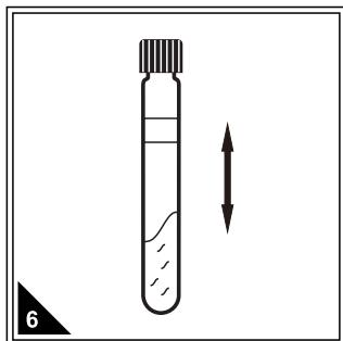
拧紧管盖，上下摇晃试管，使试剂与水样充分接触。
