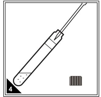
4 使用移液管或移液枪准确移取5.00mL蒸馏水，制成空白样。其他试管内准确移取5.00mL待测水样，制成待测样，记录试管上的编码。
