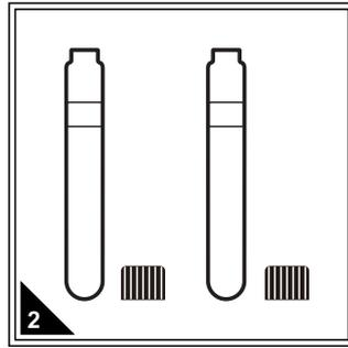
2 取若干试管，一支作为空白样，再根据待测水样的数量选择相同数量的试剂管作为待测样，拧开试管盖，置于试管架上。
