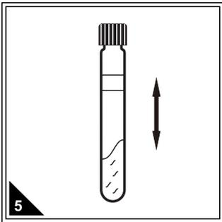
5 拧紧管盖，上下摇晃试管，使试管内的试剂与水样充分混合。
