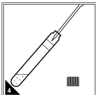
使用移液管或移液枪准确移取5.00mL的蒸馏水加到预制试剂内制成空白样。
