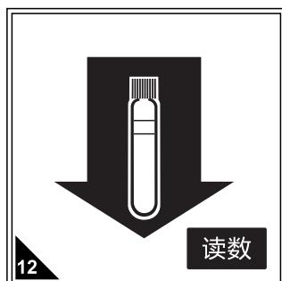
再放入待测样，按读数直接读取亚铁浓度(mg/L)，期间无需拧开瓶盖，必须保证试剂为澄清状态，如有混浊产生则无法进行读数。
