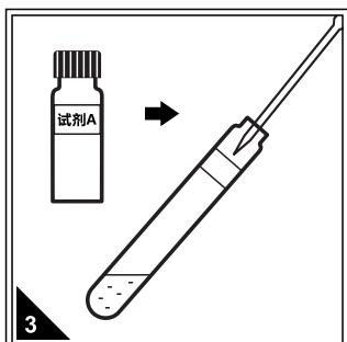
准确移取1.00mL试剂A于每支试剂管中。
