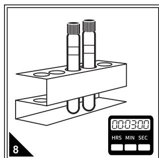
将试剂管放在试管架内，启动计时器，反应并准确计时3min。
