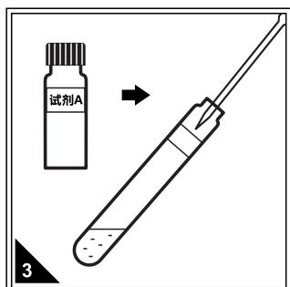
使用移液管或移液枪准确移取2.00mL试剂A加入到每支管中。
