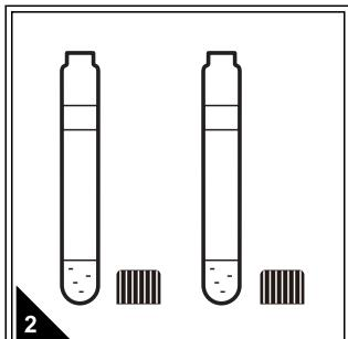
选择合适量程的预制试剂，一支作为空白样，再根据待测水样的数量选择相同数量的预制试剂作为待测样，拧开试管盖，置于试管架上。
