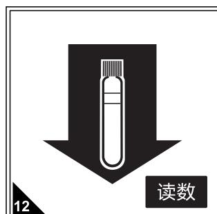
再放入待测样，按读数直接读取硝酸盐浓度（mg/L以“N”计），期间无需拧开瓶盖，必须保证试剂为澄清状态，如有混浊产生则无法进行读数。
