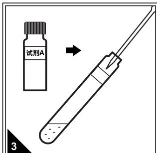
准确移取试剂A于每支试剂管中。（初次使用时，此步骤省略）
