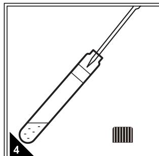
使用移液管或移液枪准确移取一定量的无氨水加入到A管内，摇匀制成空白样品。
