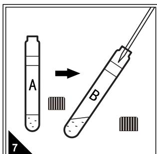
取出对应数量的B管，从A管中移取1.00mL加入到B管中，摇匀。（此时试管内试剂反应会有热量产生，建议拿握瓶盖部分以防烫伤）
