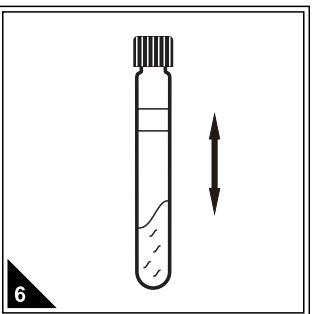
拧紧管盖，上下摇晃试管，使试剂与水样充分接触并溶解。
