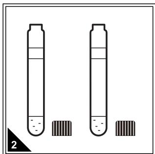
选择合适数量的预制试剂，一支作为空白样，再根据待测水样的数量选择相同数量的预制试剂作为待测样品，拧开管盖，置管架上。
