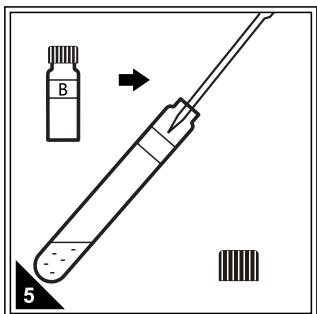
分别向每支试剂管中准确加入0.50mL试剂B。
