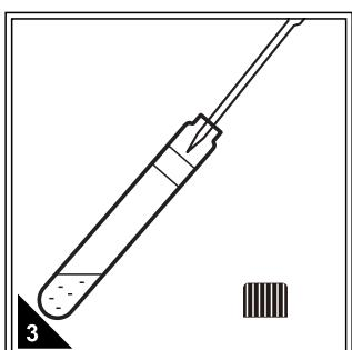
使用移液管或移液枪准确移取5.00mL的蒸馏水加入预制试剂管内制成空白样品。
