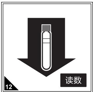
再放入待测水样，按读数直接读取镁元素浓度(mg/L)，期间无需升瓶盖，确保试剂为澄清状态，如有浑浊产生则不能进行读数。
