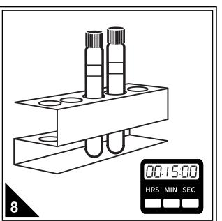
将试剂管放在试管架内，启动计时器，反应并准确计时15min。
