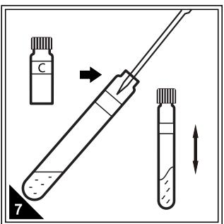
使用移液管或移液枪准确移取1.00mL试剂C，拧紧盖子上下充分摇匀。
