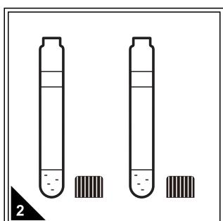
选择预制试剂若干，一支作为空白样，再根据待测水样的数量选择相同数量的预制试剂作为待测样品，拧开管盖，置管架上。
