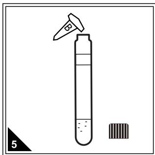
分别向每支试剂管中倒入试剂B粉剂。（全部倒入试管中并倾倒干净）
