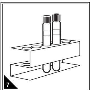
30分钟消解时间结束，消解器进行降温，手拿管盖取出试管，放入试管架中置于通风处进行冷却（快速降温也可采用冷水浴浸泡试管底部），待试管降至室温，方可进行下一步。
