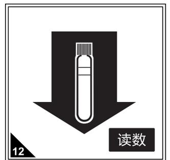
再放入待测水样，按读数直接读取甲醛浓度(mg/L)，期间无需开瓶盖，确保试剂为澄清状态，如有浑浊产生则不能进行读数。
