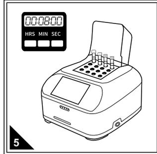
拧紧管盖，将试剂管放入预升温100°C的消解器中。启动计时器，反应并准确计时8min。
