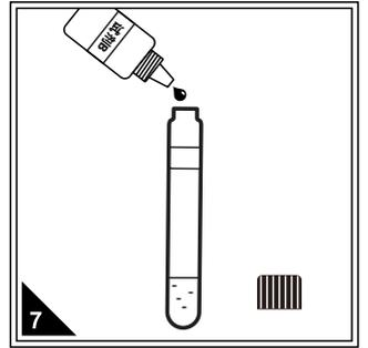
打开管盖，分别加入5滴试剂B，至溶液呈柠檬黄色。
