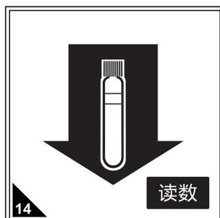
再放入待测水样，按读数直接读取硫酸盐浓度(mg/L)，期间无需开瓶盖，确保试剂为澄清状态，如有浑浊产生则不能进行读数。
