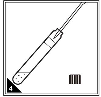
按步骤3的方法移取同体积的待测水样加入到其他预制试剂的试管内，每支预制试剂对应一个待测水样，制成待测样，记录试管上的编码。
