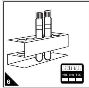
取出试剂管，室温冷却3min。
