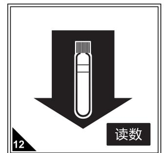
12 再放入待测样，按读数直接读取总铁浓度(mg/L)，期间无需拧开瓶盖，必须保证试剂为澄清状态，如有混浊产生则无法进行读数。
