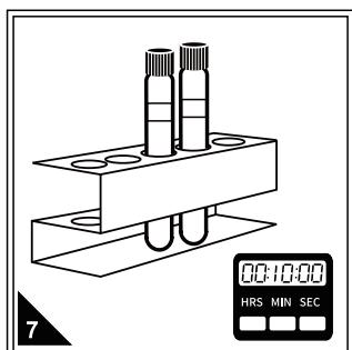
将试剂管放在试管架内，启动计时器，反应并准确计时10min。
