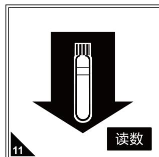
再放入待测水样，按读数直接读取锰元素浓度(mg/L)，期间无需开瓶盖，确保试剂为澄清状态，如有浑浊产生则不能进行读数。
