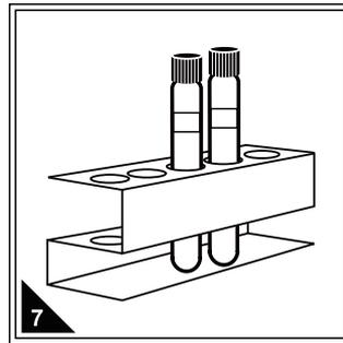
7 30分钟消解时间结束，消解器进行降温，手拿管盖取出试管，放入试管架中置于通风处进行冷却（快速降温也可采用冷水浴浸泡试管底部），待试管降至室温，方可进行下一步。
