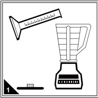
1 将待测水样按前处理要求进行混匀等操作。对于悬浮物较多的水样，应进行搅拌等匀质化处理，以减小取样误差。
