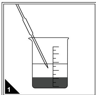
将待测水样按前处理要求进行蒸馏或絮凝沉淀等操作，保证待测水样澄清无颗粒物且透明。
