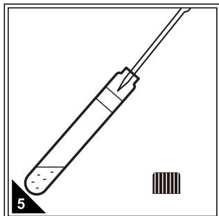
按步骤4的方法移取同体积的待测水样加入到其他预制试剂的试管内，每只预制试剂对应一个待测水样，制成待测样，记录试管上的编码。
