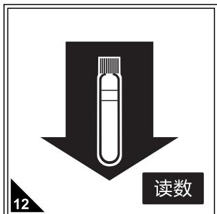
再放入待测水样，按读数直接读取铜元素浓度(mg/L)，期间无需开瓶盖，确保试剂为澄清状态，如有浑浊产生则不能进行读数。
