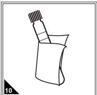
取出反应好的试管样，用擦镜布或无毛屑的软纸擦干净试管外壁。
