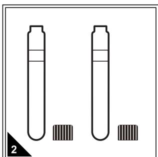
取试剂管若干，一支作为空白样，再根据待测水样的数量选择相同数量的试剂管作为待测样，置于试管架上。
