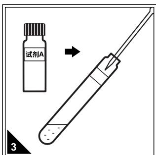
使用移液管或移液枪准确移取1.00mL试剂A加入到每支管中。
