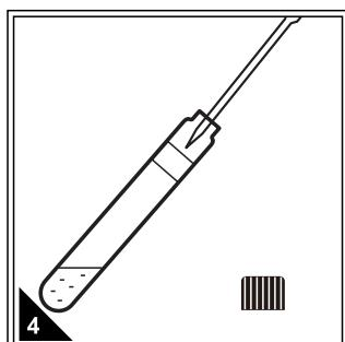
使用移液管或移液枪准确移取5.00mL蒸馏水加入预制试剂管内制成空白样品。
