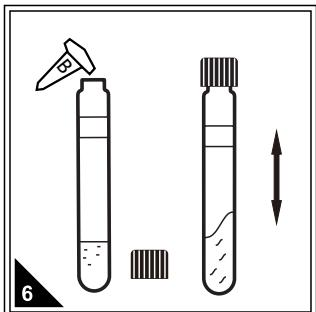
分别向每支试剂管中倒入一颗试剂B粉剂。（全部倒入试管中并倾倒干净）拧紧管盖，上下摇晃试管，使试剂与水样充分接触并溶解。
