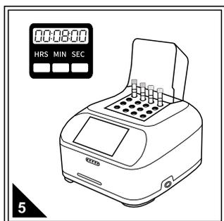
5 拧紧管盖，将试剂管放入预升温100℃的消解器中。启动计时器，反应并准确计时8min。
