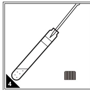
4 按步骤3的方法移取同体积的待测水样加入到其他预制试剂的试管内，每支预制试剂对应一个待测水样，制成待测样，记录试管上的编码。
