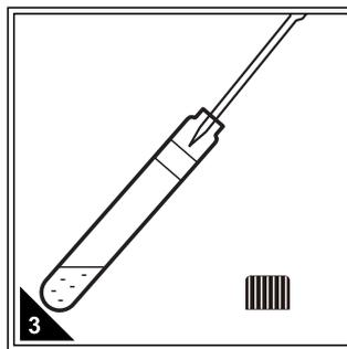
3 使用移液管或移液枪准确移取5.00mL的蒸馏水加入预制试剂管内制成空白样品。
