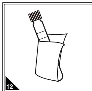
12 取出反应好的试管样，用擦镜布或无毛屑的软纸擦干净试管外壁。
