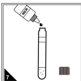
7 打开管盖，分别加入5滴试剂B，至溶液呈柠檬黄色。
