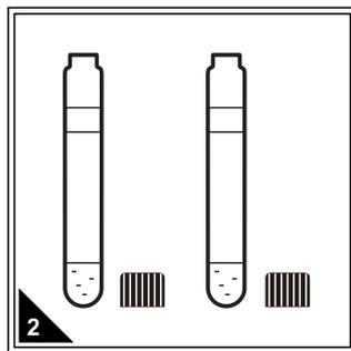
2 选择合适量程的预制试剂，一支作为空白样，再根据待测水样的数量选择相同数量的预制试剂作为待测样品，拧开管盖，置管架上。
