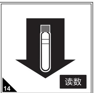
14 再放入待测水样，按读数直接读取硫酸盐浓度(mg/L)，期间无需开瓶盖，确保试剂为澄清状态，如有浑浊产生则不能进行读数。
