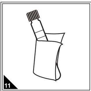
11 取出反应好的试管样，用擦镜布或无毛屑的软纸擦干净试管外壁。
