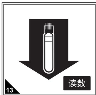
13 再放入待测样，按读数直接读取总磷浓度（mg/L以“P”计），期间无需拧开瓶盖，必须保证试剂为澄清状态，如有混浊产生则无法进行读数。
