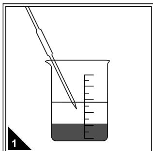
将待测水样按前处理要求进行混匀等操作。对于悬浮物较多的水样，应进行搅拌等匀质化处理，以减少取样误差。
