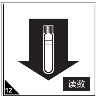
再放入待测样，按读数直接读取二氧化硅浓度(mg/L)，期间无需拧开瓶盖，必须保证试剂为澄清状态，如有浑浊产生则无法进行读
