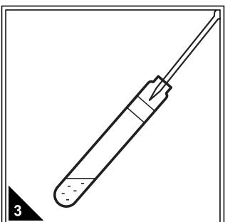
准确移取5.00mL纯水于试管中，制成空白样记录编号。
