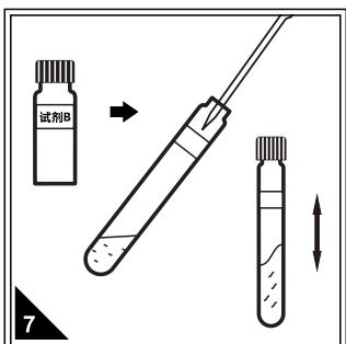
依次向各试管中加入1.00mL试剂B。拧紧管盖，上下摇晃试管，使试剂与水样充分接触。
